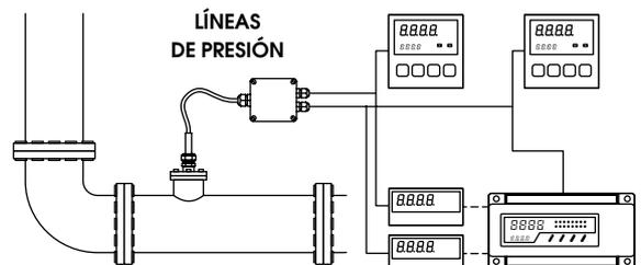
Instalación típica de una **THR-370/RS** para control y registro de HR y temperatura en frigorífico.
