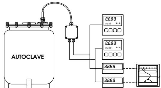
Instalación típica de una **THR-370/RS** para control y registro de HR y temperatura en un invernadero o secadero de embutidos, tabaco, etc.
