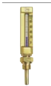
Cuerpo de Aluminio 110 x 30 mm, forma B según DIN 16181 Conexión G 1/2 A o 1/2" NPT, versión recta
