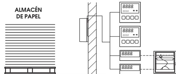
Instalación típica de una TTA-370 para control y registro de temperatura en un almacén.
