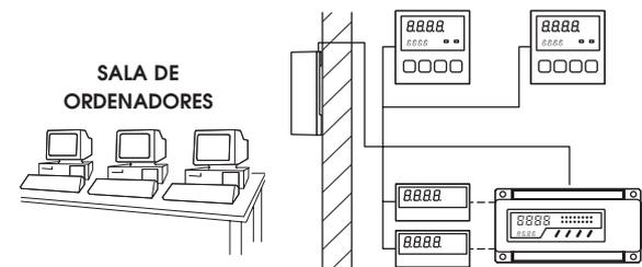
Instalación típica de una TTA-370 para control y registro de temperatura en salas estériles.
