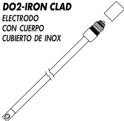
Diseñado para uso en fermentadores con acceso superior. Tiene una funda de inox A-316 de longitud extra para alcanzar el líquido. Se ofrece con punta para autoclave. El cable de interconexión de baja impedancia es de 1 m de largo y lleva conector BNC
