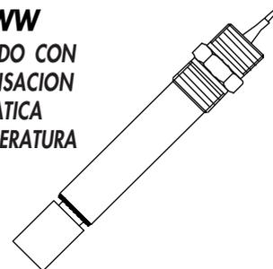
Este sensor de oxígeno disuelto para aguas residuales dispone de compensación automática de temperatura en el margen de 15 a 60 °C con un error menor del 1%. Tiene cuerpo de polímero reforzado y punta con membrana de fácil recambio, cable de 4,6 m y conector BNC
