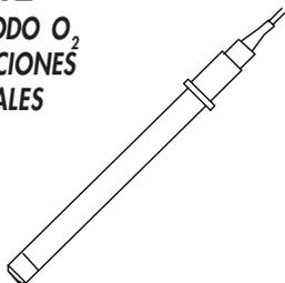
Es un sensor galvánico de oxígeno disuelto sellado y de tipo desechable. Está diseñado para uso continuo en esterilización por vapor en fermentadores. La duración y estabilidad a largo término frente a alta temperatura lo hace ideal para DO2 en autoclaves. Puede ser utilizado en laboratorio o en proceso con adaptador de 3/4" NPT o por brida de 25 mm
