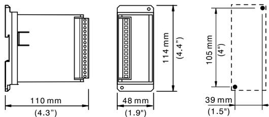
Montaje en raíl DIN simétrico: EN 50022 (DIN 46277-3)
