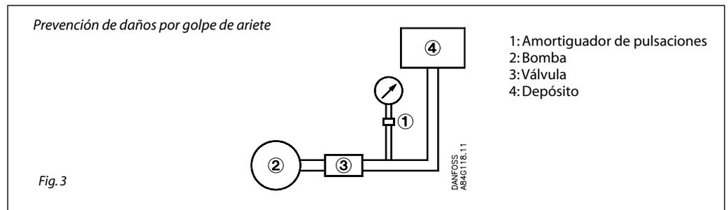
En casos de cierre momentáneo de la válvula, pueden aparecer picos de presión cuyo valor sobrepasa el asignado al elemento de presión. Para evitar daños al elemento de presión en estos casos, debería montarse un dispositivo amortiguador.
