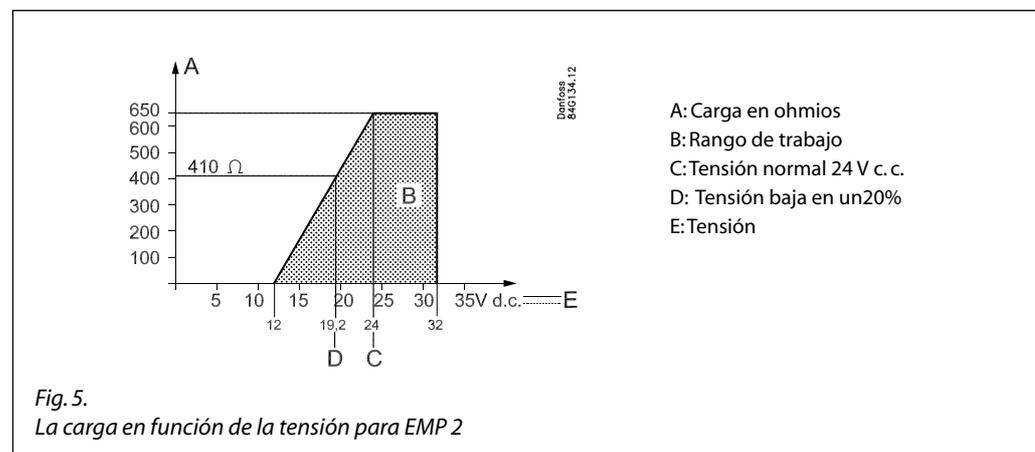
Fig. 5. La carga en función de la tensión para EMP 2
