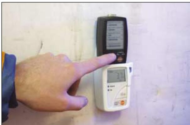
El recolector de datos de bolsillo testo 580 transmite datos desde los loggers in situ para descargar con PC
