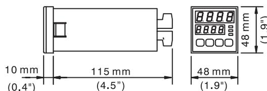
Montaje panel: taladro de 45 x 45<sup>+0.5</sup><sub>-0</sub> mm (1.8" x 1.8" <sup>+0.2</sup><sub>-0</sub>)
