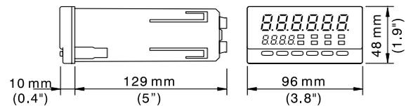
Montaje panel: taladro de 90 x 45<sup>+0,5</sup><sub>-0</sub> mm (3.5" x 1.8" <sup>+0,2</sup><sub>-0</sub>)
