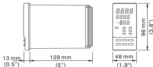
Montaje panel: taladro de 90 x 45 <sup>+0,5</sup>/<sub>-0</sub> mm (3.5" x 1.8" <sup>+0,2</sup>/<sub>-0</sub>)
