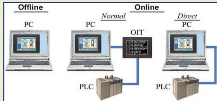
A través de los tres modos de **simulación** posibles podrá depurar sus proyectos hasta conseguir las prestaciones que requiera en sus aplicaciones, **visualizando resultados en su PC**, con el terminal y el PLC conectados o no. Incluso podrá manejar terminales remotos vía Internet...
