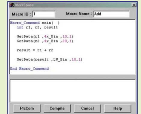
Cree sus **Macros/Scripts** con un potente **lenguaje tipo "C"** para la realización de operaciones aritméticas, escalados, etc., y asíelos a objetos de pantalla o directamente a registros del PLC para su ejecución.
